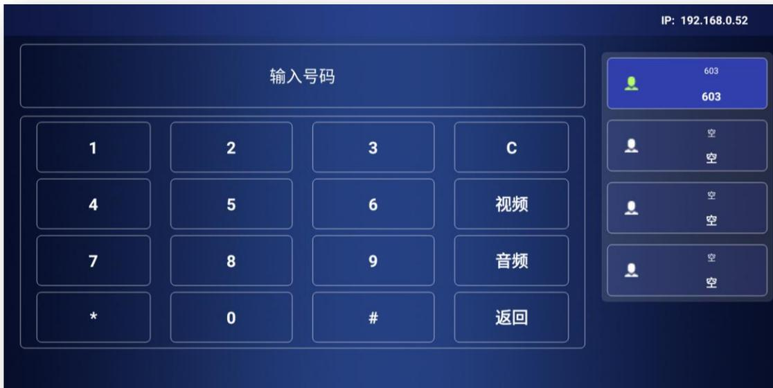
输入号码后通过选择的 SIP 账号进行音频/音频通话。
